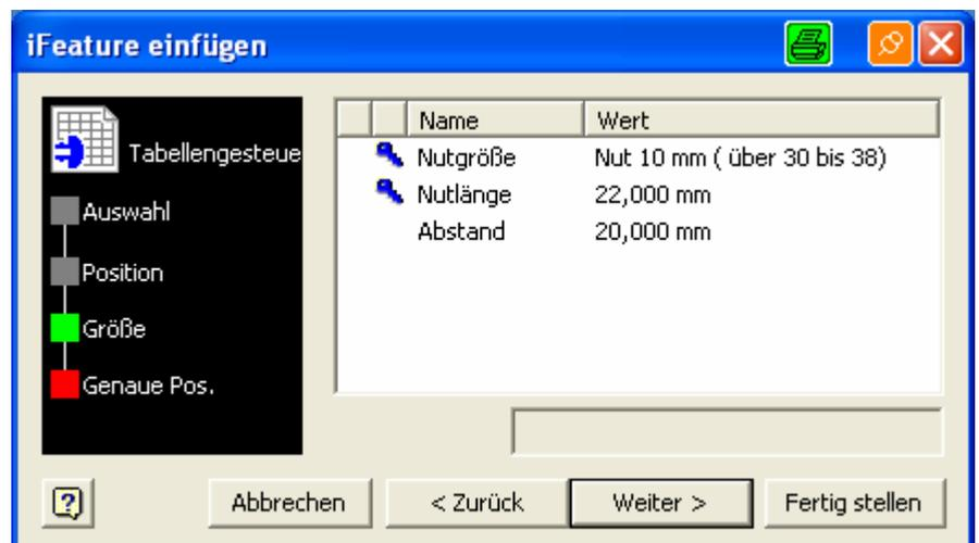
Die Nutbreite ist unabhängig vom Durchmesser des angewählten Zylinders, als Information ist hinter dem Wert (z. B. Nut 10 mm) die Angabe, für welchen Durchmesserbereich (Text in Klammern: z. B. über 30 bis 38) diese Nutbreite nach Norm verwendet wird. Somit können auch „ungenormte“ Paßfedernuten erstellt werden.
