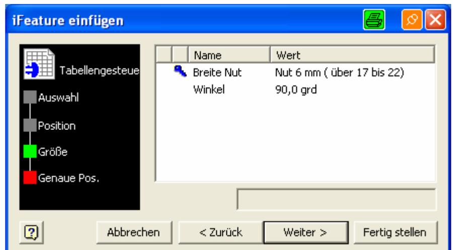
Die Nutbreite ist unabhängig vom Durchmesser der angewählten Bohrung, als Information ist hinter dem Wert (z. B. Nut 6 mm) die Angabe, für welchen Durchmesserbereich (Text in Klammern: z. B. über 17 bis 22) diese Nutbreite nach Norm verwendet wird. Somit können auch „ungenormte“ Paßfedernuten erstellt werden.
