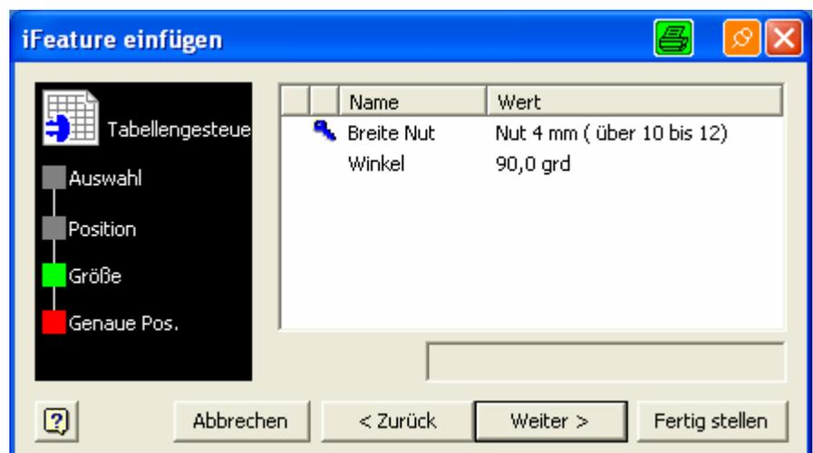
Die Nutbreite ist unabhängig vom Durchmesser der angewählten Bohrung, als Information ist hinter dem Wert (z. B. Nut 4 mm) die Angabe, für welchen Durchmesserbereich (Text in Klammern: z. B. über 10 bis 12) diese Nutbreite nach Norm verwendet wird. Somit können auch „ungenormte“ Keilnuten erstellt werden.
