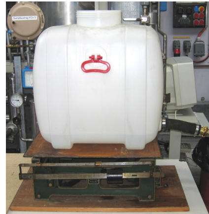
Abb. 4-8 Testaufbau Gesamthöhen und Volumenströme
